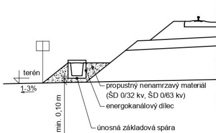
Obrázek 5a – Umístění a způsob uložení kabelové trasy mezi hranici pozemku dráhy a patu náspu
